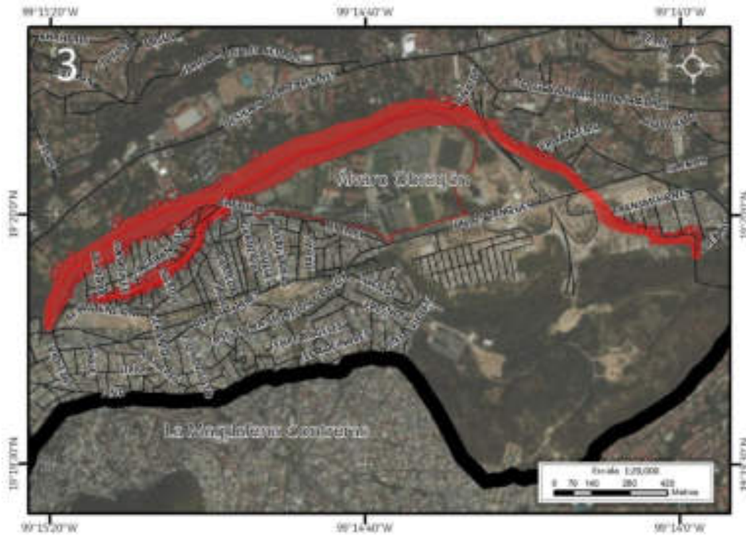
Figura 5.25. Imagen 3 donde se muestra el riesgo por derrumbe en Malinche (Mapa XXI). Nota: el número en la parte superior izquierda representa la ubicación del sitio de estudio en el mapa, la línea roja corresponde al cauce de la barranca, el sombreado en rojo representa el polígono de peligro, los recuadros con contorno rojo representan los lotes con vulnerabilidad alta, las líneas negras simbolizan el eje vial y la línea negra de mayor grosor corresponde al límite delegacional.
