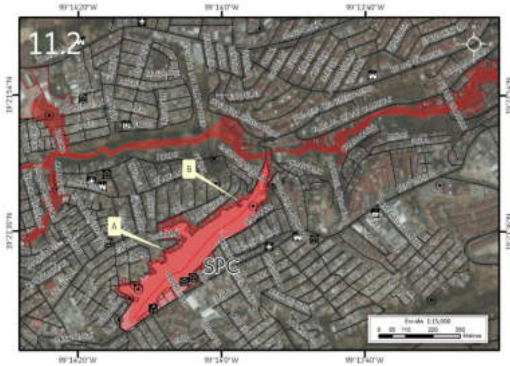
Figura 5.103. Sección dos (11.2) en donde se muestra el riesgo por derrumbe en Río Mixcoac (Imagen 11). Nota: el número en la esquina superior izquierda representa la ubicación y la sección del polígono, la línea roja corresponde al cauce de la barranca, el sombreado en rojo representa el polígono de peligro, los recuadros con contorno rojo representan los lotes con vulnerabilidad alta, el coral representa el sitio con riesgo (SPC, 2014), los octógonos negros con punto al centro representan los reportes de antecedentes, las líneas negras simbolizan el eje vial y las etiquetas indican las fotografías que ilustran el peligro en el lugar. Para otras simbologías revisar el Anexo III.
