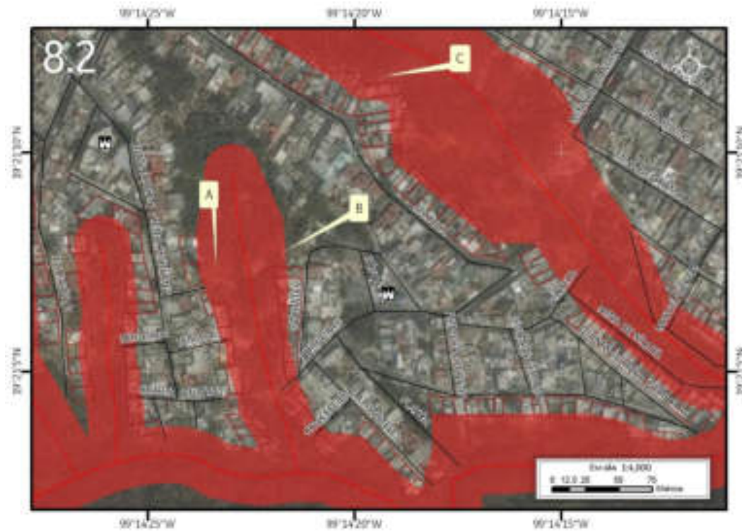
Figura 5.82. Sección dos (8.2) en donde se muestra el riesgo por derrumbe en Puerta Grande (Imagen 8). Nota: el número en la esquina superior izquierda representa la ubicación y la sección del polígono, la línea roja corresponde al cauce de la barranca, el sombreado en rojo representa el polígono de peligro, las líneas negras simbolizan el eje vial, los recuadros rojos son los lotes con vulnerabilidad alta y las etiquetas indican las fotografías que ilustran el peligro en el lugar. Para otras simbologías revisar el Anexo III.
