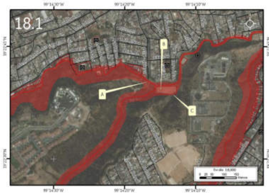
Figura 5.148. Sección uno (18.1) en donde se muestra el riesgo por derrumbe y deslizamiento en Tlalpizahuaya (Imagen 18). Nota: el número en la esquina superior izquierda representa la ubicación y la sección del polígono, la línea roja corresponde al cauce de la barranca, el sombreado en rojo representa el polígono de peligro, los recuadros con contorno rojo representan los lotes con vulnerabilidad alta, el octágono con punto negro al centro es un reporte de antecedente, las líneas negras simbolizan el eje vial y las etiquetas indican las fotografías que ilustran el peligro en el lugar. Para otras simbologías revisar el Anexo III.
