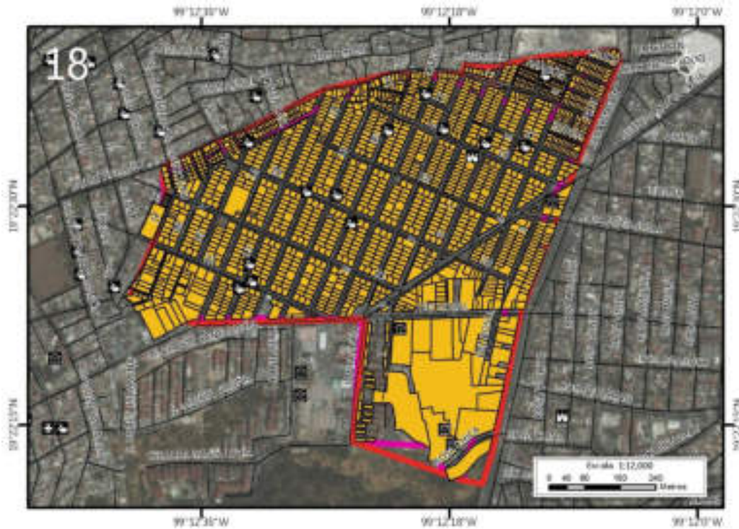
Figura 5.204. Imagen 18 donde se muestra el riesgo por fracturamiento en Olivar del Conde 1.ª Sección (Mapa XXV). Nota: el número en la parte superior izquierda representa la ubicación del sitio de estudio en el mapa, la línea roja corresponde al polígono de peligro, los recuadros amarillos representan los lotes vulnerables, el contorno rosa representa el polígono de la PAOT (2010) y las líneas negras simbolizan el eje vial. Para otras simbologías revisar el Anexo III.
