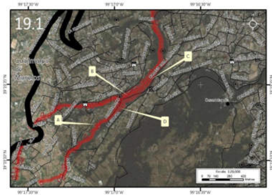
Figura 5.159. Sección uno (19.1) en donde se muestra el riesgo por derrumbe en Atzoyapan (Imagen 19). Nota: el número en la esquina superior izquierda representa la sección del polígono, la línea roja corresponde al cauce de la barranca, el sombreado en rojo representa el polígono de peligro, los recuadros con contorno rojo representan los lotes con vulnerabilidad alta, el punto negro representa una localidad rural, los octágonos con punto negro al centro son los reportes de antecedentes, las líneas negras simbolizan el eje vial, la línea negra de mayor grosor corresponde al límite delegacional y las etiquetas indican las fotografías que ilustran el peligro en el lugar. Para otras simbologías revisar el Anexo III.
