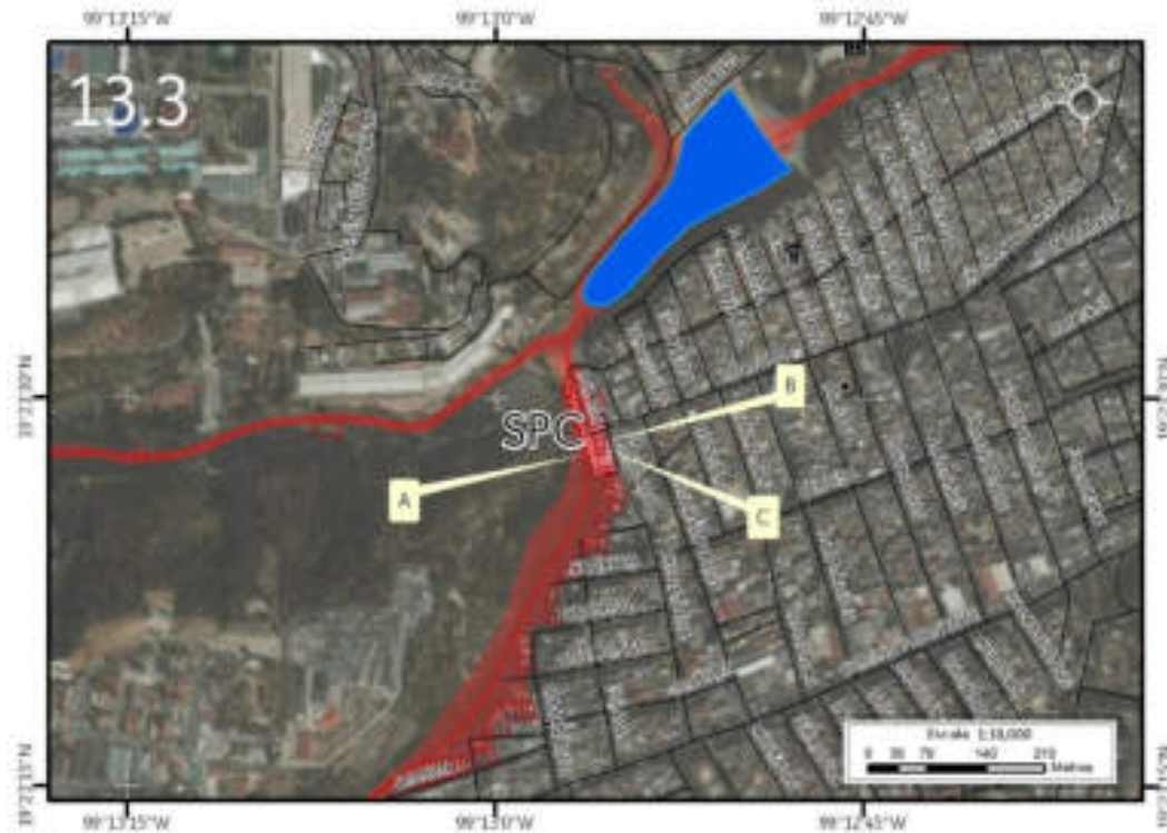
Figura 5.120. Sección tres (13.3) en donde se muestra el riesgo por derrumbe en Tacubaya (Imagen 13). Nota: el número en la esquina superior izquierda representa la ubicación y la sección del polígono, la línea roja corresponde al cauce de la barranca, el sombreado en rojo representa el polígono de peligro, los recuadros con contorno rojo representan los lotes con vulnerabilidad alta, el octógono negro con punto al centro representa un reporte de antecedente, en coral el sitio con riesgo (SPC, 2014), las líneas negras simbolizan el eje vial, el polígono azul corresponde a un cuerpo de agua perenne y las etiquetas indican las fotografías que ilustran el peligro en el lugar. Para otras simbologías revisar el Anexo III.
