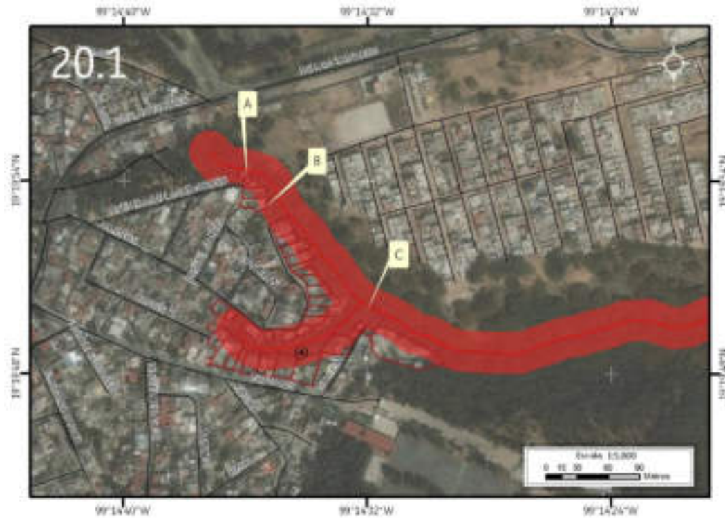
Figura 5.168. Sección uno (20.1) en donde se muestra el riesgo por derrumbe en Parque La Loma (Imagen 20). Nota: el número en la esquina superior izquierda representa la sección del polígono, la línea roja corresponde al cauce de la barranca, el sombreado en rojo representa el polígono de peligro, los recuadros con contorno rojo representan los lotes con vulnerabilidad alta, el octágono con punto negro al centro es un reporte de antecedente, las líneas negras simbolizan el eje vial y las etiquetas indican las fotografías que ilustran el peligro en el lugar.
