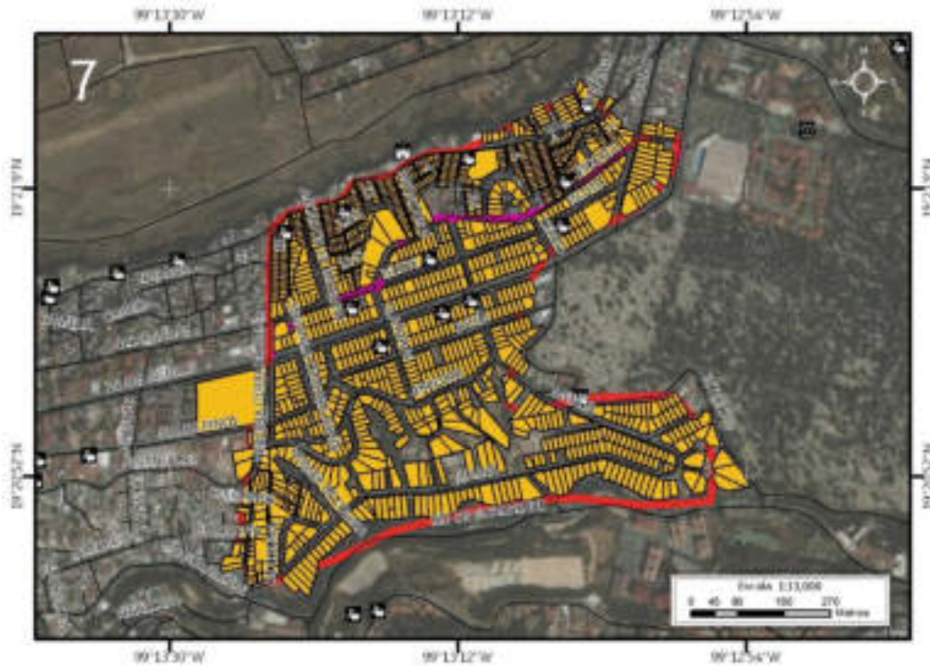
Figura 5.193. Imagen 7 donde se muestra el riesgo por fracturamiento en Ampliación Las Águilas (Mapa XXV). Nota: el número en la parte superior izquierda representa la ubicación del sitio de estudio en el mapa, la línea roja corresponde al polígono de peligro, los recuadros amarillos representan los lotes vulnerables, el contorno rosa representa el polígono de la PAOT (2010) y las líneas negras simbolizan el eje vial. Para otras simbologías revisar el Anexo III.
