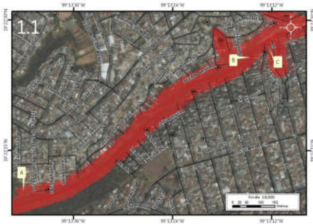
Figura 5.5. Sección uno (1.1) en donde se muestra el riesgo por derrumbe, deslizamiento y flujo de lodo en Río San Borja (Imagen 1). Nota: el número en la esquina superior izquierda representa la ubicación y la sección del polígono, la línea roja corresponde al cauce de la barranca, el sombreado en rojo representa el polígono de peligro, los recuadros con contorno rojo representan los lotes con vulnerabilidad alta, los octágonos negros con punto al centro representan los reportes de antecedentes, las líneas negras simbolizan el eje vial y las etiquetas indican las fotografías que ilustran el peligro en el lugar.
