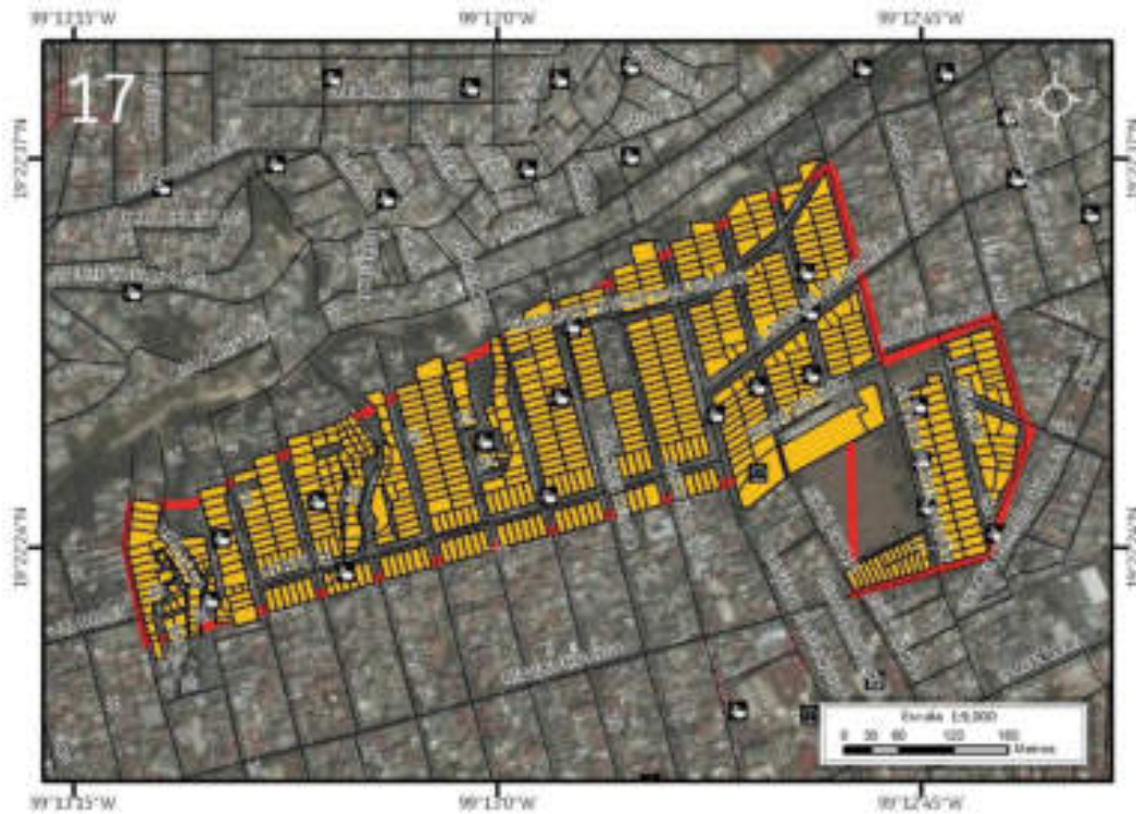
Figura 5.203. Imagen 17 donde se muestra el riesgo por fracturamiento en Olivar del Conde 2.ª Sección (Mapa XXV). Nota: el número en la parte superior izquierda representa la ubicación del sitio de estudio en el mapa, la línea roja corresponde al polígono de peligro, los recuadros amarillos representan los lotes vulnerables y las líneas negras simbolizan el eje vial. Para otras simbologías revisar el Anexo III.
