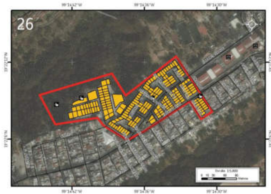
Figura 5.212. Imagen 26 donde se muestra el riesgo por fracturamiento en Jalalpa El Grande II (Mapa XXV). Nota: el número en la parte superior izquierda representa la ubicación del sitio de estudio en el mapa, la línea roja corresponde al polígono de peligro, los recuadros amarillos representan los lotes vulnerables y las líneas negras simbolizan el eje vial. Para otras simbologías revisar el Anexo III.
