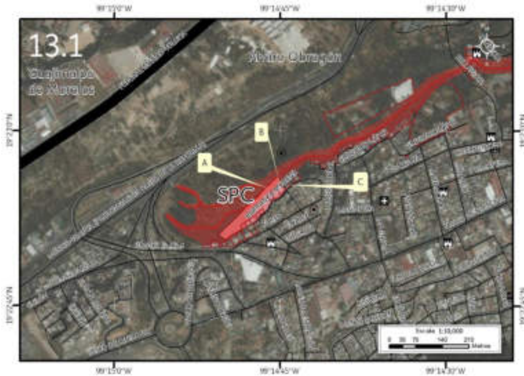
Figura 5.112. Sección uno (13.1) en donde se muestra el riesgo por derrumbe en Tacubaya (Imagen 13). Nota: el número en la esquina superior izquierda representa la ubicación y la sección del polígono, la línea roja corresponde al cauce de la barranca, el sombreado en rojo representa el polígono de peligro, los recuadros con contorno rojo representan los lotes con vulnerabilidad alta, los octógonos con punto negro al centro son los reportes de antecedentes, en coral el sitio con riesgo (SPC, 2014), las líneas negras simbolizan el eje vial, la línea negra de mayor grosor corresponde al límite delegacional y las etiquetas indican las fotografías que ilustran el peligro en el lugar. Para otras simbologías revisar el Anexo III.
