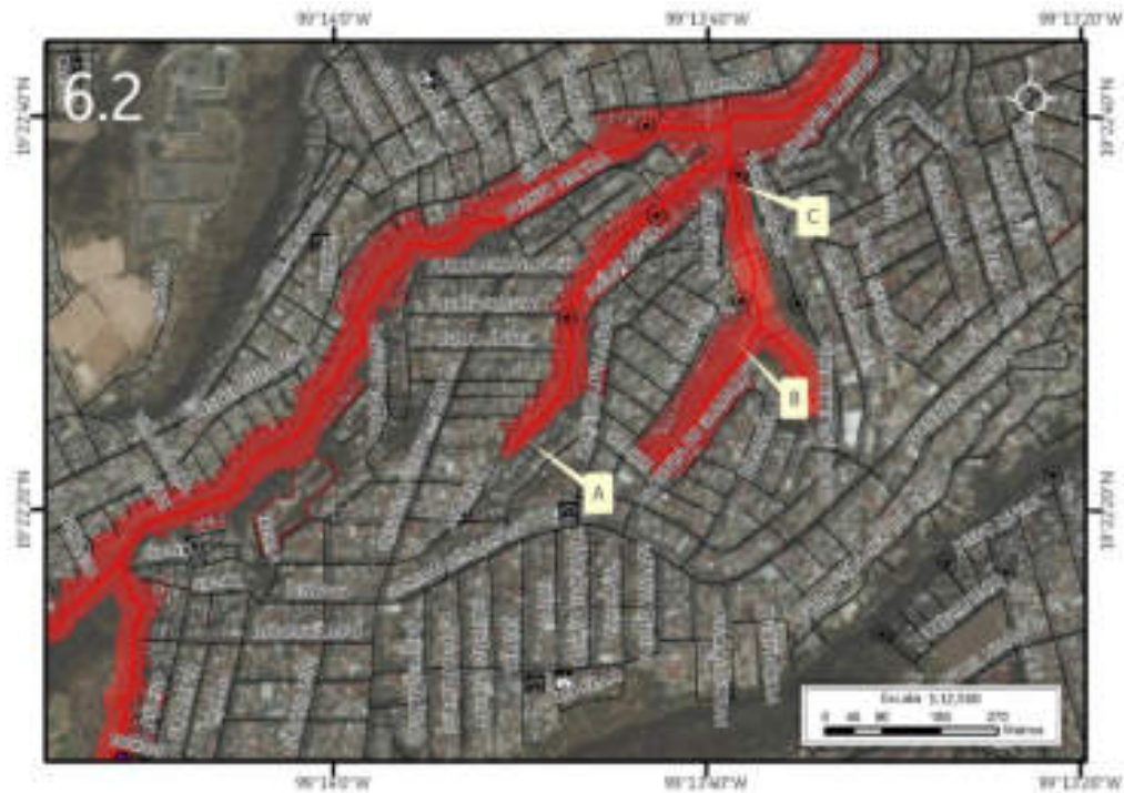
Figura 5.63. Sección 2 (6.2) en donde se muestra el riesgo por derrumbe en Río Becerra (Imagen 6). Nota: el número en la esquina superior izquierda representa la ubicación y la sección del polígono, la línea roja corresponde al cauce de la barranca, el sombreado en rojo representa el polígono de peligro, los recuadros rojos son los lotes en vulnerabilidad alta, las líneas negras simbolizan el eje vial, los octógonos negros con un punto al centro representan los reportes de antecedentes y las etiquetas indican las fotografías que ilustran el peligro en el lugar. Para otras simbologías revisar el Anexo III.
