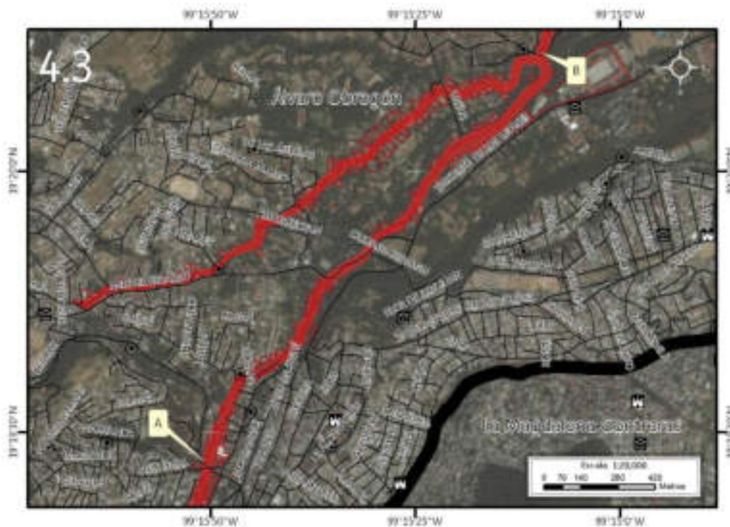
Figura 5.43. Sección tres (4.3) en donde se muestra el riesgo por derrumbe en Guadalupe (Imagen 4). Nota: el número en la esquina superior izquierda representa la ubicación y la sección del polígono, la línea roja corresponde al cauce de la barranca, el sombreado en rojo representa el polígono de peligro, los recuadros con contorno rojo representan los lotes con vulnerabilidad alta, los octógonos negros con punto al centro representan los reportes de antecedentes, las líneas negras simbolizan el eje vial, la línea negra de mayor grosor corresponde al límite delegacional y las etiquetas indican las fotografías que ilustran el peligro en el lugar. Para otras simbologías revisar el Anexo III.
