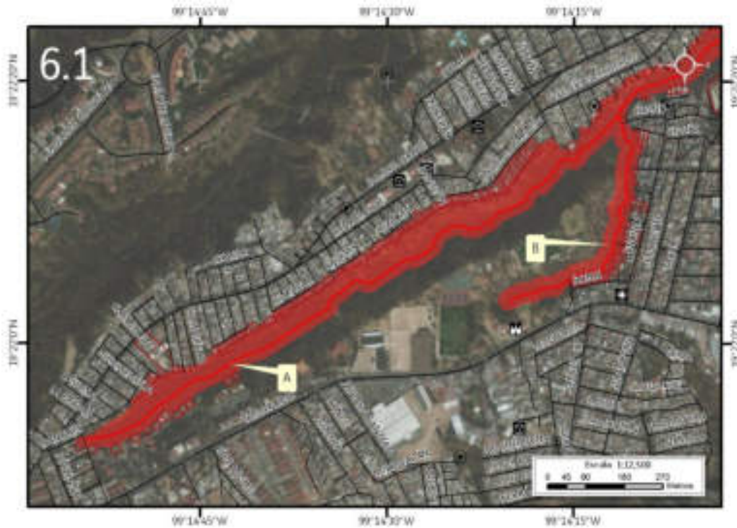
Figura 5.60. Sección uno (6.1) en donde se muestra el riesgo por derrumbe en Río Becerra (Imagen 6). Nota: el número en la esquina superior izquierda representa la ubicación y la sección del polígono, la línea roja corresponde al cauce de la barranca, el sombreado en rojo representa el polígono de peligro, los recuadros rojos son los lotes en vulnerabilidad alta, las líneas negras simbolizan el eje vial, los octágonos negros con punto al centro son los reportes de antecedentes y las etiquetas indican las fotografías que ilustran el peligro en el lugar. Para otras simbologías revisar el Anexo III.
