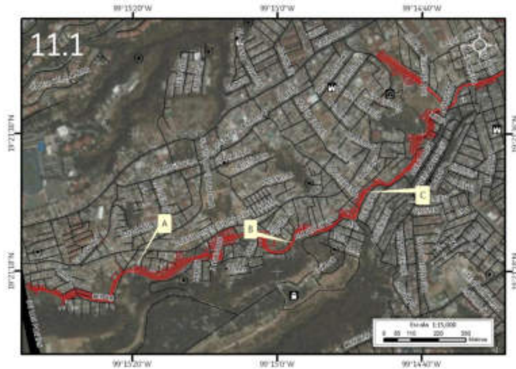
Figura 5.99. Sección uno (11.1) en donde se muestra el riesgo por derrumbe en Río Mixcoac (Imagen 11). Nota: el número en la esquina superior izquierda representa la ubicación y la sección del polígono, la línea roja corresponde al cauce de la barranca, el sombreado en rojo representa el polígono de peligro, los recuadros con contorno rojo representan los lotes con vulnerabilidad alta, los octágonos negros con punto al centro representan los reportes de antecedentes, las líneas negras simbolizan el eje vial, la línea negra de mayor grosor corresponde al límite delegacional y las etiquetas indican las fotografías que ilustran el peligro en el lugar. Para otras simbologías revisar el Anexo III.
