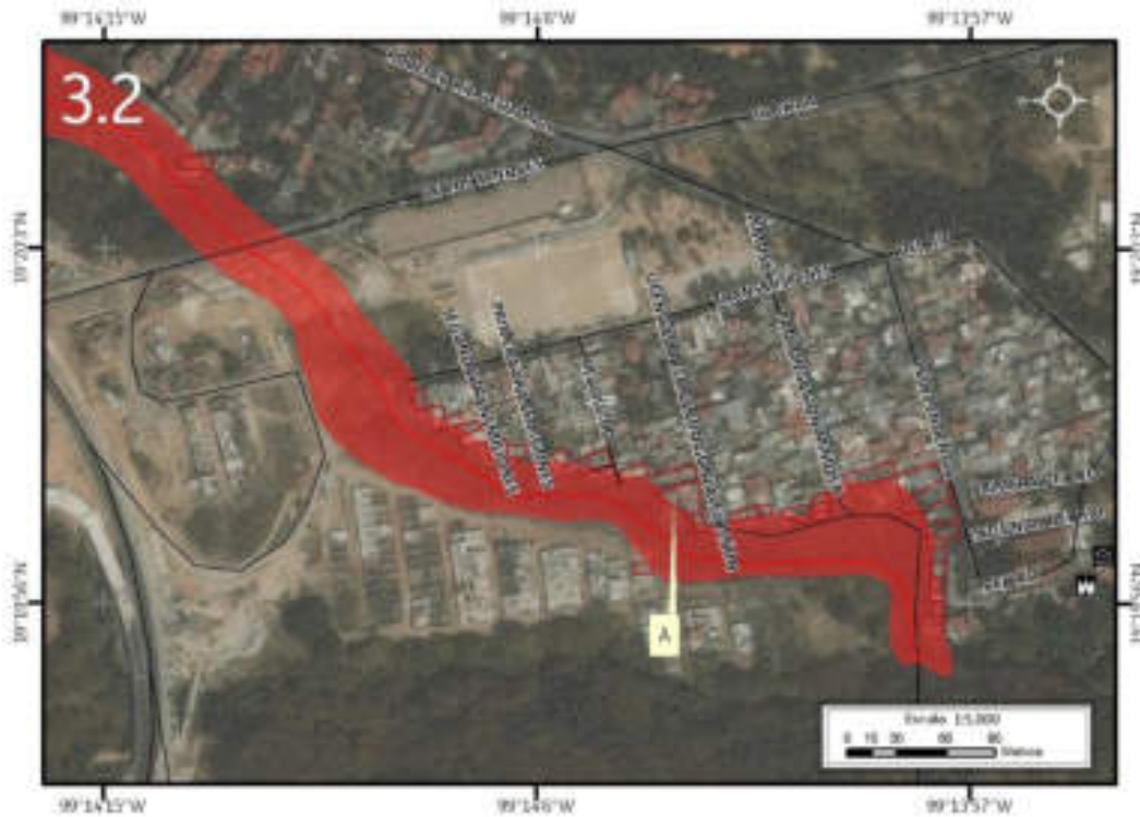
Figura 5.32. Sección dos (3.2) en donde se muestra el riesgo por derrumbe en la barranca Malinche (Imagen 3). Nota: el número en la esquina superior izquierda representa la ubicación y la sección del polígono, la línea roja corresponde al cauce de la barranca, el sombreado en rojo representa el polígono de peligro, los recuadros con contorno rojo representan los lotes con vulnerabilidad alta, las líneas negras simbolizan el eje vial y la etiqueta indica la fotografía que ilustra el peligro en el lugar. Para otras simbologías revisar el Anexo III.
