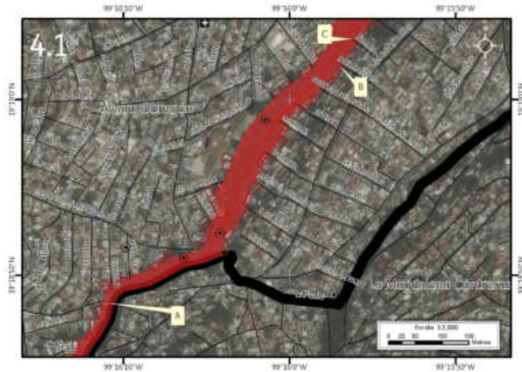
Figura 5.35. Sección uno (4.1) en donde se muestra el riesgo por derrumbe en Guadalupe (Imagen 4). Nota: el número en la esquina superior izquierda representa la ubicación y la sección del polígono, la línea roja corresponde al cauce de la barranca, el sombreado en rojo representa el polígono de peligro, los recuadros con contorno rojo representan los lotes con vulnerabilidad alta, los octágonos negros con punto al centro representan los reportes de antecedentes, las líneas negras simbolizan el eje vial, la línea negra de mayor grosor corresponde al límite delegacional y las etiquetas indican las fotografías que ilustran el peligro en el lugar. Para otras simbologías revisar el Anexo III.
