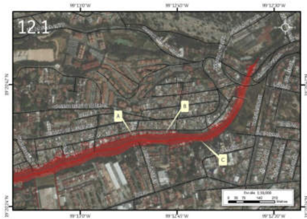
Figura 5.107. Sección uno (12.1) en donde se muestra el riesgo por derrumbe en El Moral (Imagen 12). Nota: el número en la esquina superior izquierda representa la ubicación y la sección del polígono, la línea roja corresponde al cauce de la barranca, el sombreado en rojo representa el polígono de peligro, los recuadros con contorno rojo representan los lotes con vulnerabilidad alta, las líneas negras simbolizan el eje vial y las etiquetas indican las fotografías que ilustran el peligro en el lugar.
