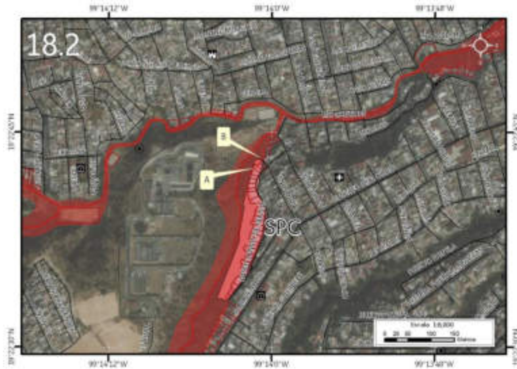
Figura 5.152. Sección 2 (18.2) en donde se muestra el riesgo por derrumbe y deslizamiento en Tlalpizahuaya (Imagen 18). Nota: el número en la esquina superior izquierda representa la ubicación y la sección del polígono, la línea roja corresponde al cauce de la barranca, el sombreado en rojo representa el polígono de peligro, los recuadros con contorno rojo representan los lotes con vulnerabilidad alta, en coral el sitio con riesgo (SPC, 2014), los octágonos con punto negro al centro son los reportes de antecedentes, las líneas negras simbolizan el eje vial y las etiquetas indican las fotografías que ilustran el peligro en el lugar. Para otras simbologías revisar el Anexo III.
