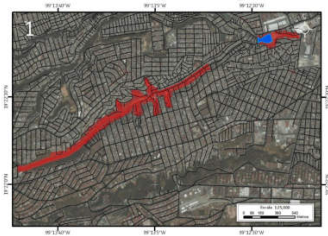
Figura 5.4. Imagen 1 donde se muestra el riesgo por derrumbe, deslizamiento y flujo de lodo en Río San Borja (Mapa XXI). Nota: el número en la parte superior izquierda representa la ubicación del sitio de estudio en el mapa, la línea roja corresponde al cauce de la barranca, el sombreado en rojo representa el polígono de peligro, los recuadros con contorno rojo representan los lotes con vulnerabilidad alta, las líneas negras simbolizan el eje vial y el polígono azul corresponde a cuerpos de agua perenne.
