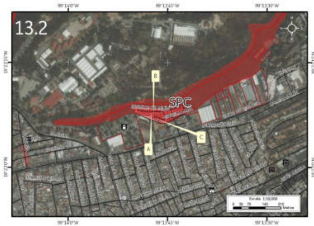
Figura 5.116. Sección dos (13.2) en donde se muestra el riesgo por derrumbe en Tacubaya (Imagen 13). Nota: el número en la esquina superior izquierda representa la ubicación y la sección del polígono, la línea roja corresponde al cauce de la barranca, el sombreado en rojo representa el polígono de peligro, los recuadros con contorno rojo representan los lotes con vulnerabilidad alta, en coral el sitio con riesgo (SPC, 2014), las líneas negras simbolizan el eje vial y las etiquetas indican las fotografías que ilustran el peligro en el lugar. Para otras simbologías revisar el Anexo III.
