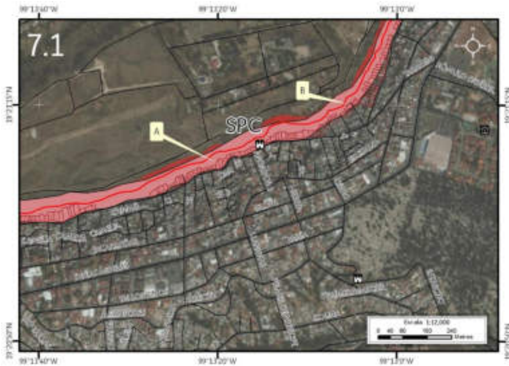
Figura 5.71. Sección uno (7.1) en donde se muestra el riesgo por derrumbe en Tarango (Imagen 7). Nota: el número en la esquina superior izquierda representa la ubicación y la sección del polígono, la línea roja corresponde al cauce de la barranca, el sombreado en rojo representa el polígono de peligro, las líneas negras simbolizan el eje vial, los recuadros rojos son los lotes vulnerables, el coral es para el sitio con riesgo (SPC, 2014) y las etiquetas indican las fotografías que ilustran el peligro en el lugar. Para otras simbologías revisar el Anexo III.
