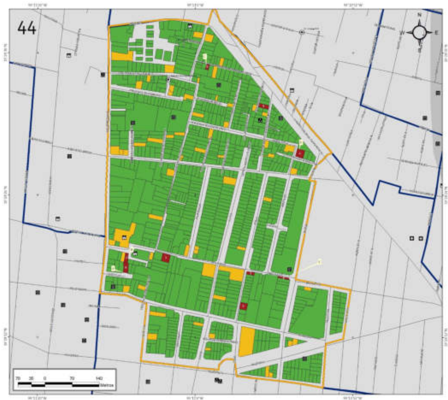
Figura 5.259. Imagen 44, de la zona El Recreo. Nota: el número de la parte superior izquierda hace referencia a la ubicación de la zona en el Mapa XVI. En color rojo se observa la vulnerabilidad física alta (grado de daño \geq 3 ), en color amarillo los lotes vulnerables (grado de daño 2) y en color verde la vulnerabilidad física baja (grado de daño 1). Los números ubicados dentro de los lotes corresponden a la vulnerabilidad social. Las líneas azules delimitan los límites entre colonias, los tonos grises corresponden al hundimiento regional, las líneas negras delgadas corresponden al eje vial, la línea amarilla delimita la zona El Recreo, los octógonos negros indican puntos de antecedentes, las etiquetas blancas hacen referencia a las fotografías que ilustran la vulnerabilidad de dicho lote. Para otras simbologías revisar el Anexo III.
