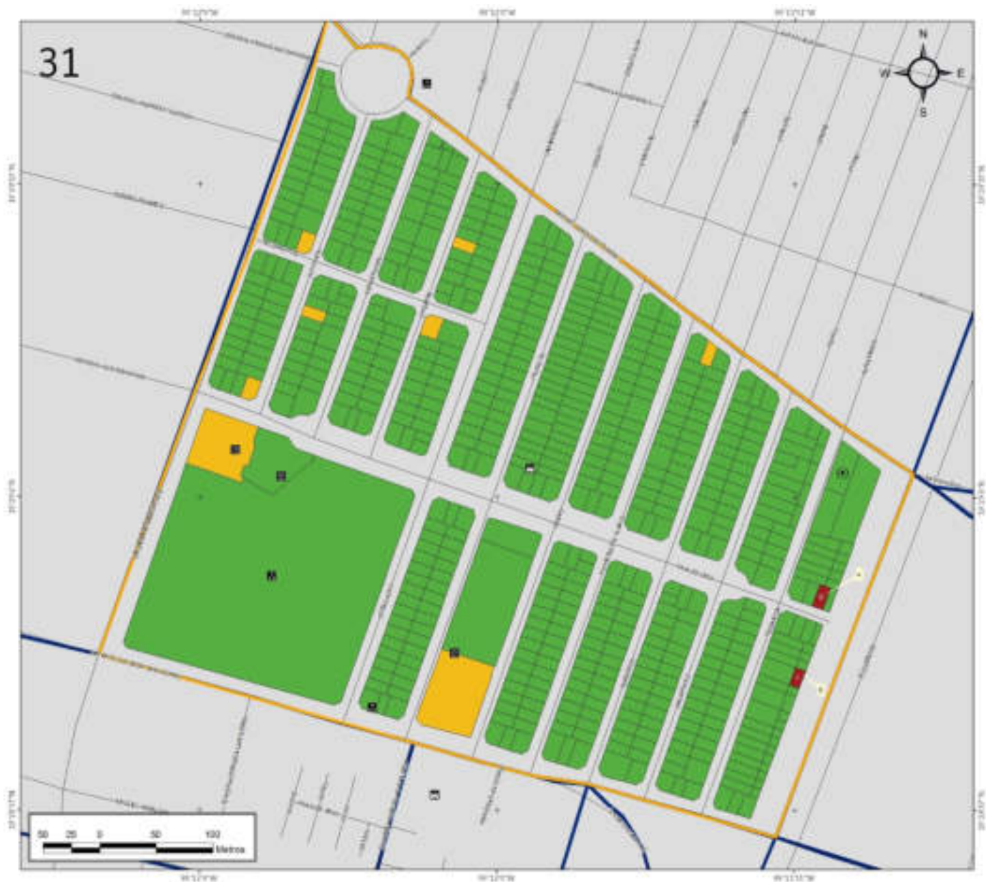
Figura 5.187. Imagen 31, de la zona Petrolera. Nota: el número de la parte superior izquierda hace referencia a la ubicación de la zona en el Mapa XVI. En color rojo se observa la vulnerabilidad física alta (grado de daño \geq 3 ), en color amarillo los lotes vulnerables (grado de daño 2) y en color verde la vulnerabilidad física baja (grado de daño 1). El número dentro del lote indica la vulnerabilidad social. Las líneas azules delimitan los límites entre colonias, los tonos grises corresponden al hundimiento regional, las líneas negras delgadas corresponden al eje vial, la línea amarilla delimita la zona Petrolera, el octógono negro con un punto al centro representa un punto de antecedente, las etiquetas blancas hacen referencia a las fotografías que ilustran la vulnerabilidad de dicho lote. Para otras simbologías revisar el Anexo III.
