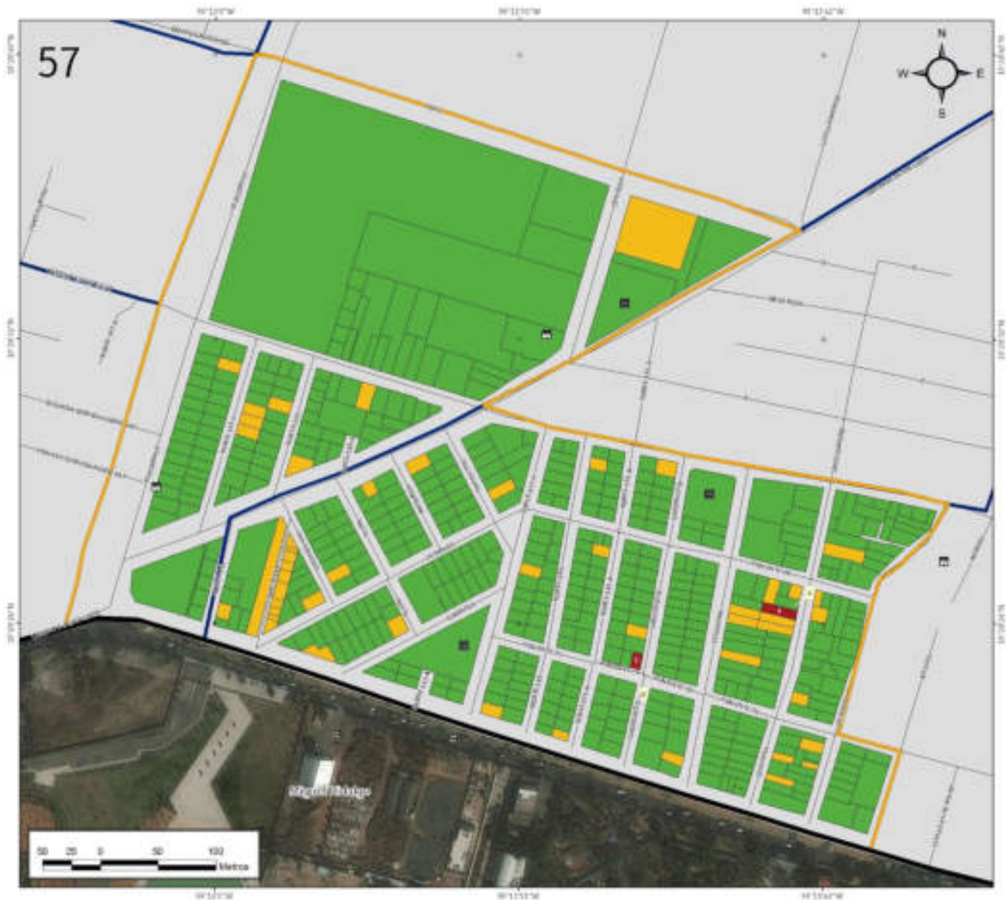
Figura 5.324. Imagen 57, de la zona Santa Lucía/Plenitud. Nota: el número de la parte superior izquierda hace referencia a la ubicación de la zona en el Mapa XVI. En color rojo se observa la vulnerabilidad física alta (grado de daño \geq 3 ), en color amarillo los lotes vulnerables (grado de daño 2) y en color verde la vulnerabilidad física baja (grado de daño 1). El número dentro del lote indica la vulnerabilidad social. Las líneas azules delimitan los límites entre colonias, los tonos grises corresponden al hundimiento regional, las líneas negras delgadas corresponden al eje vial, la línea amarilla delimita la zona Santa Lucía/Plenitud, la línea negra gruesa representa el límite de la Delegación Azcapotzalco, las etiquetas blancas hacen referencia a las fotografías que ilustran la vulnerabilidad de dicho lote. Para otras simbologías revisar el Anexo III.
