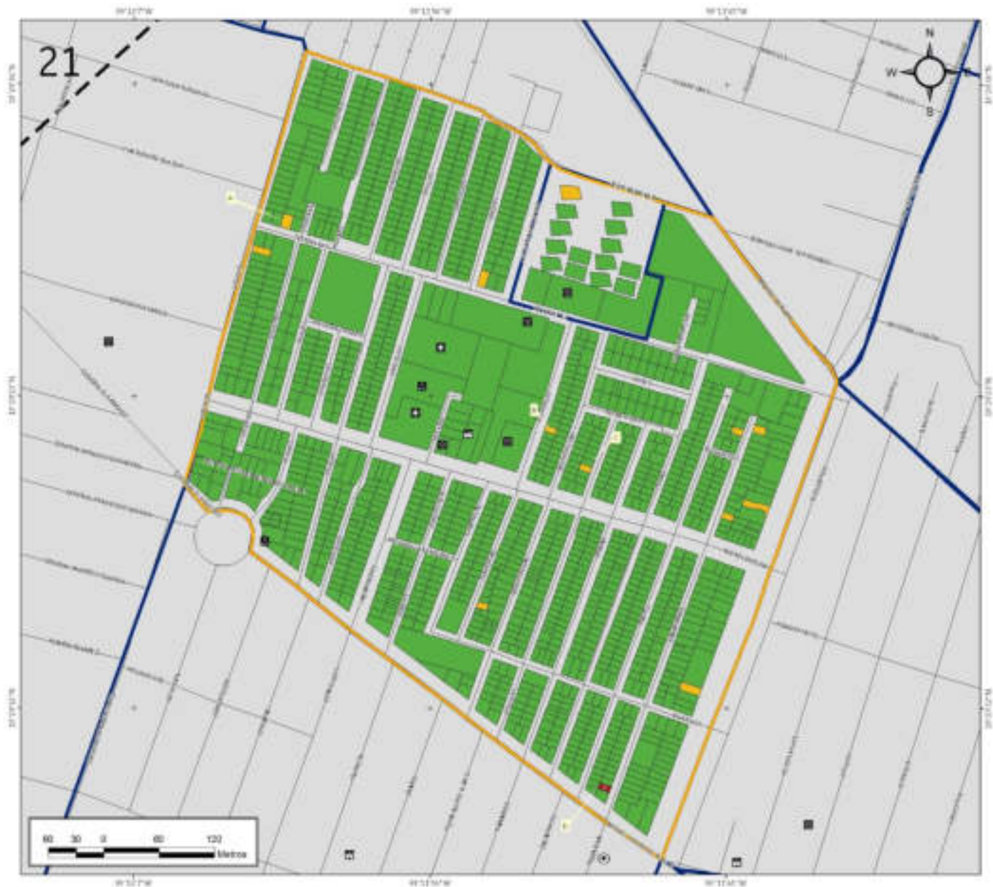
Figura 5.131. Imagen 21, de la zona Tezozómoc. Nota: el número de la parte superior izquierda hace referencia a la ubicación de la zona en el Mapa XVI. En color rojo se observa la vulnerabilidad física alta (grado de daño \geq 3 ), en color amarillo los lotes vulnerables (grado de daño 2) y en color verde la vulnerabilidad física baja (grado de daño 1). Los números al interior de los lotes indican la vulnerabilidad social. Las líneas azules delimitan los límites entre colonias, los tonos grises corresponden al hundimiento regional, las líneas negras delgadas corresponden al eje vial, la línea amarilla delimita la zona Tezozómoc, el octágono negro con un punto al centro indica un punto de antecedente, la línea negra punteada representa una falla inferida, las etiquetas blancas hacen referencia a las fotografías que ilustran la vulnerabilidad de dicho lote. Para otras simbologías revisar el Anexo III.
