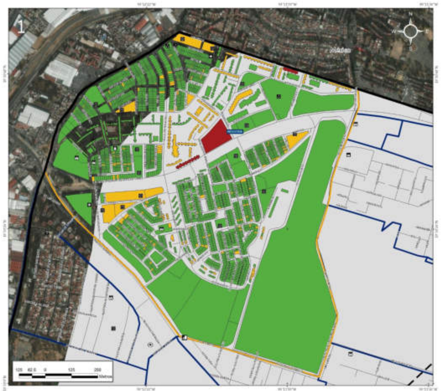
Figura 5.6. Imagen 1, de la zona EL Rosario. Nota: el número de la parte superior izquierda hace referencia a la ubicación de la zona en el Mapa XVI. En color rojo se observa la vulnerabilidad física alta (grado de daño \geq 3 ), en color amarillo los lotes vulnerables (grado de daño 2) y en color verde la vulnerabilidad física baja (grado de daño 1). Las etiquetas azules indican el uso de suelo de los inmuebles. Las líneas azules delimitan los límites entre colonias, la línea amarilla indica la zona de estudio (El Rosario) los octógonos negros con un punto al centro indican los reportes de antecedentes, la línea negra discontinúa representa la falla inferida, los tonos grises corresponden al hundimiento regional. La línea negra gruesa indica los límites de la Delegación Azcapotzalco, las líneas negras delgadas representan el eje vial. Para otras simbologías revisar el Anexo III.
