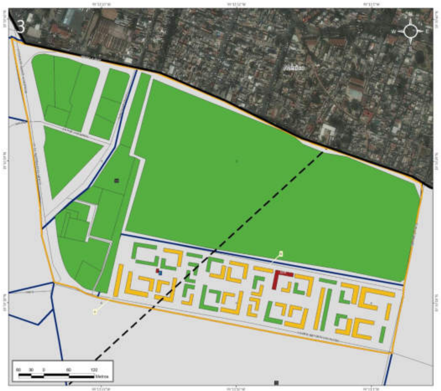
Figura 5.18. Imagen 3, de la zona San Pablo Xalpa. Nota: el número de la parte superior izquierda hace referencia a la ubicación de la zona en el Mapa XVI. En color rojo se observa la vulnerabilidad física alta (grado de daño \geq 3 ), en color amarillo los lotes vulnerables (grado de daño 2) y en color verde la vulnerabilidad física baja (grado de daño 1). El número ubicado dentro del lote corresponde a la vulnerabilidad social, la etiqueta azul y letra indican el uso de suelo del inmueble. Las líneas azules delimitan los límites entre colonias, la línea negra gruesa discontinúa representa una falla inferida, los tonos grises corresponden al hundimiento regional. La línea negra gruesa indica los límites de la Delegación Azcapotzalco, las líneas negras delgadas corresponden al eje vial, la línea amarilla delimita la zona San Pablo Xalpa; las etiquetas blancas hacen referencia a las fotografías que ilustran la vulnerabilidad de dicho lote. Para otras simbologías revisar el Anexo III.
