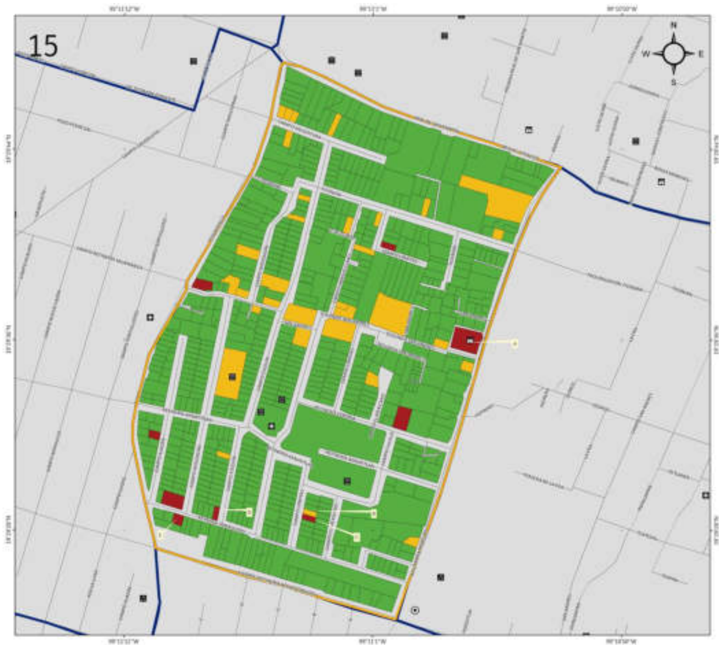
Figura 5.95. Imagen 15, de la zona San Andrés. Nota: el número de la parte superior izquierda hace referencia a la ubicación de la zona en el Mapa XVI. En color rojo se observa la vulnerabilidad física alta (grado de daño \geq 3 ), en color amarillo los lotes vulnerables (grado de daño 2) y en color verde la vulnerabilidad física baja (grado de daño 1). Los números ubicados dentro de los lotes corresponden a la vulnerabilidad social. Las líneas azules delimitan los límites entre colonias, el octágono negro con un punto al centro indican los reportes de antecedentes, los tonos grises corresponden al hundimiento regional, las líneas negras delgadas corresponden al eje vial, la línea amarilla delimita la zona San Andrés; las etiquetas blancas hacen referencia a las fotografías que ilustran la vulnerabilidad de dicho lote. Para otras simbologías revisar el Anexo III.
